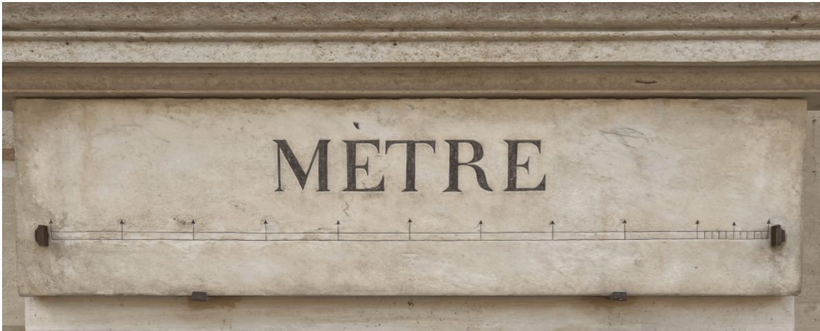
Materialització de la longitud després de la Revolució Francesa: patró públic del metre, plaça Vendôme, París.
